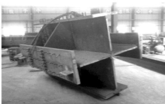
图 15 工厂内钢构件各零件焊接加工成型
